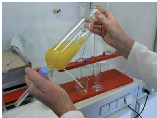
Bild 6: Flüssig-Flüssig-Extraktion von Plutonium aus einer Luftstaubprobe.
