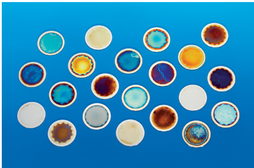
Bild 5: Auswahl typischer Messpräparate für die Alphaspektrometrie. Diese Art der Färbung oder der Musterung sagen nichts über die Qualität der Präparate oder die radiochemische Ausbeute aus. Der Durchmesser der Stahlplättchen beträgt 30 mm, der effektive Durchmesser des Präparates beträgt 25 mm.
