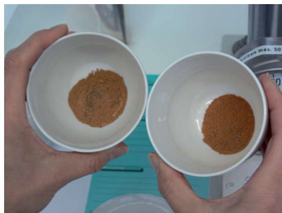
Bild 5: Bei der Veraschung des Filters entstehen 0,5 g bis 1,5 g Asche.
